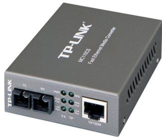
Le convertisseur de média MC110CS est conçu pour convertir une fibre optique 100BASE-FX vers un support en cuivre 100Base-TX et inversement. Conçu selon les normes IEEE802.3u 10/100Base-TX et 100Base-FX, le MC110CS doit être employé avec un câble à fibre monomode et un connecteur de type SC. Le MC110CS prend en charge la spécification du laser grandes ondes (LX) à la vitesse maximale de transmission.
