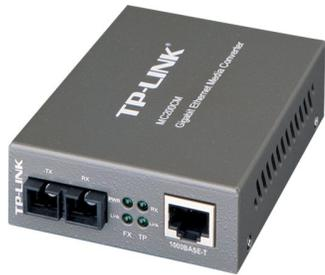
Le convertisseur de média MC200CM est conçu pour convertir une fibre 1000BASE-SX vers un support en cuivre 1000Base-T et inversement. Le MC200CM prend en charge la spécification du laser ondes courtes (SX) à la vitesse maximale de transmission. La transmission et la réception de données fonctionnent à 850 nm.
