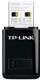
L'adaptateur USB TL-WN823N de TP-LINK est une mini clé sans fil N qui permet aux utilisateurs de relier un ordinateur de bureau ou portable à un réseau sans fil et de profiter des performances d'une haute vitesse sans fil. De conception ergonomique avec sa petite taille, cet adaptateur est pratique et facile à transporter. Avec ses caractéristiques diverses, le TL-WN823N est un excellent choix pour profiter d'un réseau sans fil rapide.
