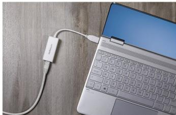
L'adaptateur USB 3.0 vers Ethernet Gigabit USB31000SW ajoute un port Ethernet RJ45 à un système informatique compatible USB avec une prise en charge des connexions de réseau Gigabit sur toute la bande passante lorsqu'il est utilisé avec une connexion hôte USB 3.0, contrairement aux adaptateurs USB 2.0.
