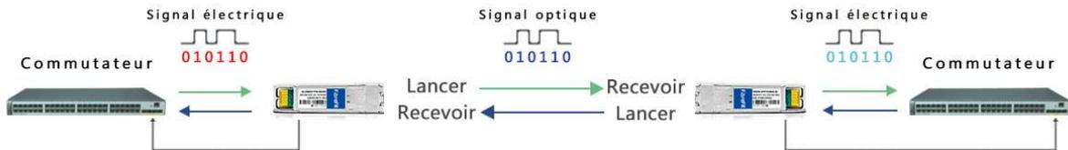
Signal optique : La lumière est représentée par 1, pas de lumière et la lumière faible par zéro
