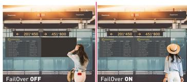
FailOver est une fonction qui détecte automatiquement les sources d'entrée. Lorsqu'il n'y a pas de signal sur l'entrée par défaut, il passera automatiquement à la prochaine entrée disponible. FailOver permet aux clients de hiérarchiser un certain nombre d'entrées (y compris le navigateur, le lecteur multimédia et personnalisé) et garantit que votre contenu est toujours affiché activement.
