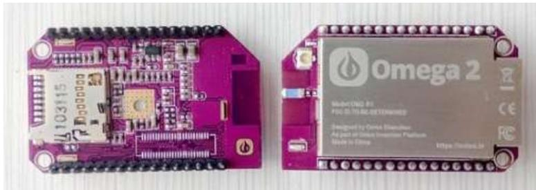
Contenant un microprocesseur System-on-a-chip, une DRAM DDR2, une mémoire flash, une antenne chip et des composants supplémentaires, l'Omega2 plus est incroyablement intégré.
