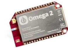
Module IoT, subminiature, facile à utiliser, l'Omega2 Plus est une plateforme microcontrôlée capable d'embarquer un système d'exploitation Linux. version avec 32 M Flash - 128 M DDR et connecteur microSD™.
