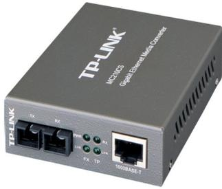
Le convertisseur de média MC210CS est conçu pour convertir une fibre optique 1000BASE-LX/LH vers un support en cuivre 1000Base-T et inversement. Le MC210CS prend en charge la spécification du laser grandes ondes (LX) à la vitesse maximale de transmission. La transmission et la réception de données fonctionnent à 1310 nm.
