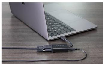
Cet adaptateur USB-C vers VGA vous permet de connecter votre ordinateur portable ou MacBook avec un port USB Type-C à un écran VGA. L'adaptateur USB-C est doté de la technologie USB Power Delivery, ce qui vous permet d'alimenter votre ordinateur portable lorsque vous diffusez de la vidéo, en utilisant le même port USB-C. L'adaptateur est également disponible en blanc (CDP2VGAUCPW), ce qui vous permet de choisir un adaptateur qui correspond au style de votre ordinateur portable.
