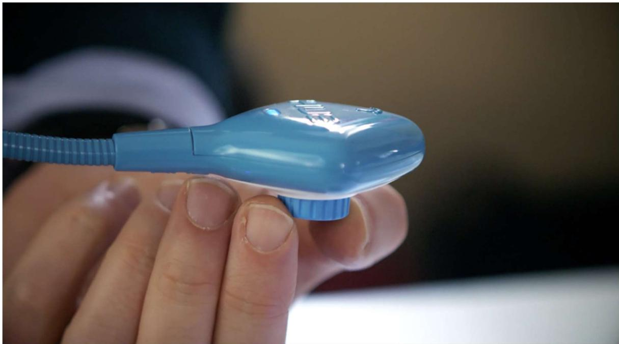
Éclairage LED et microphone intégrés. L'objectif à mise au point manuelle est idéal pour l'animation image par image, sans les ajustements intempestifs d'un autofocus. La caméra a une résolution vidéo native Full HD de 1920×1080 (16:9 1080p). La qualité peut être réduite sur des écrans de résolution inférieure.
